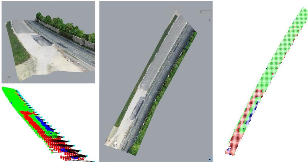
Abbildung 43: Exemplarische Abbildung einer ausgewerteten Punktwolke
